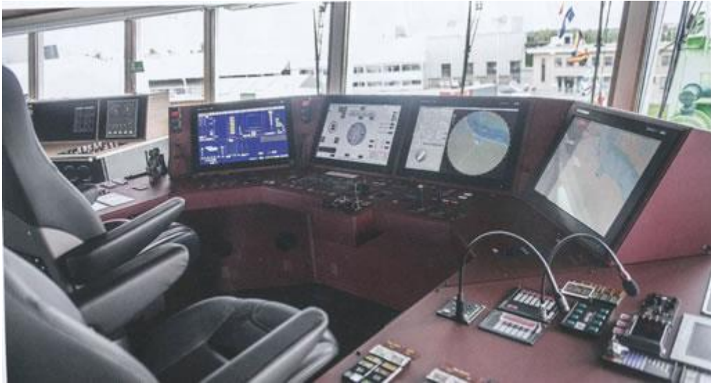
DE BRUG VAN DE SCHELDT RIVER SCHELDT IS ONDER MEER VOORZIEN VAN EEN DYNAMIC POSITIONING & DYNAMIC TRACKING (DP/DT) SYSTEEM. FOTO: ERIK VAN HUIZEN
