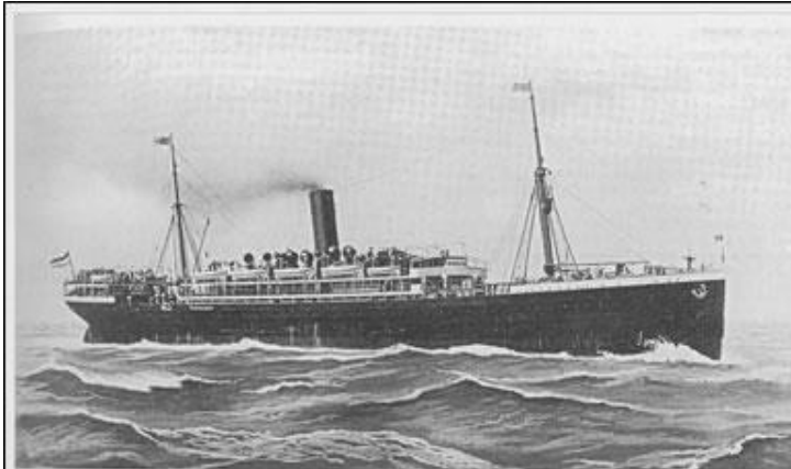
Deutsch sind auf dem Böcksdeck der Gneisenau die vielen Windhutzen erkennbar die in tropischen Gewässern für ein erträg- liches Klima im Schiffswesen sorgen.
