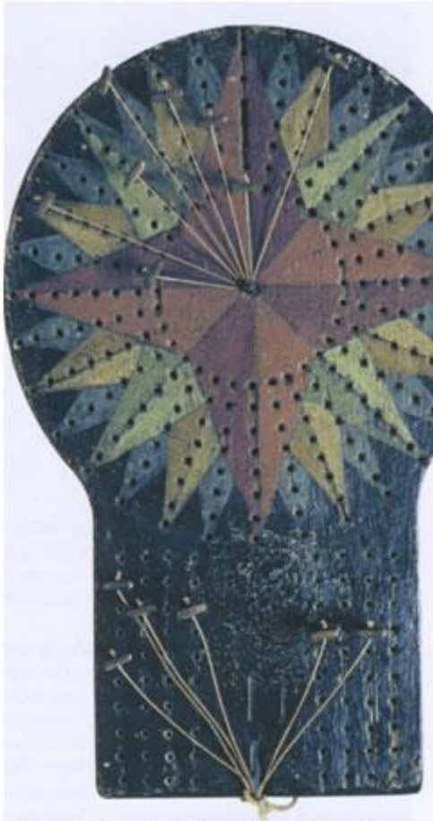
Le renard est une planchette sur laquelle figurent les trente-deux aires de vent de la boussole. Chaque aire est percée de huit trous. Toutes les demi-heures, on place une cheville sur celle suivant laquelle on vient de gouverner. Huit demi-heures correspondent à un quart complet.
