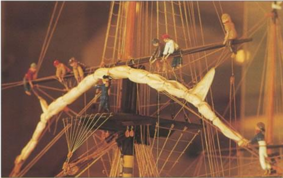
Cette maquette réalisée pour le musée de la Compagnie des Indes au Port-Louis présente avec réalisme différents écorchés des aménagements et des scènes de la vie à bord de la Syrine , un vaisseau de 400 tonneaux plus petit que le Royal Philippe . Ici, les gabiers dans la mâture enverguent un hunier.
