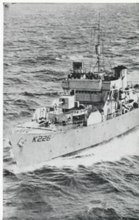
Le corvette Godetia : 1.000 tonnes, un canon de 102 mm, des mortiers et grenadeurs ASM, des 20 mm AA, 100 hommes d'équipage, 16 nœuds. Commandant : lieutenant de vaisseau Larose.
